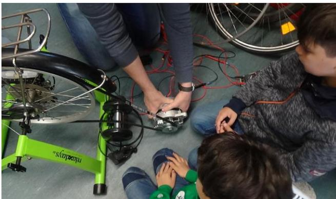
Jetzt wird die Lichtmaschine eingesetzt. Der Keilriemen ist gespannt und rutscht nicht durch.
